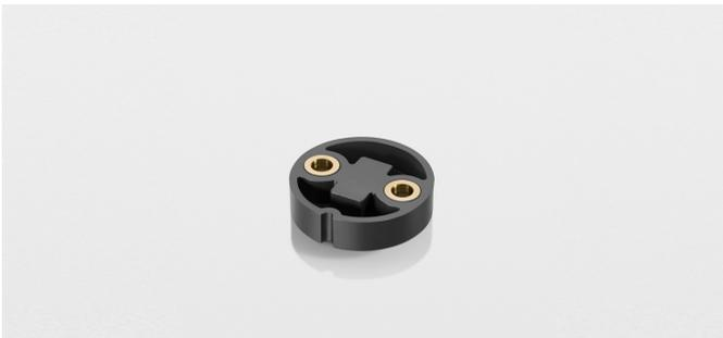
该传感器通过感知磁场方向的变化，来确定需要测量的角度。一般情况，客户提供的转动的机件轴上装有磁块，机件轴转动造成磁场方向变化，该变化被传感器的集成电路反应出来，经过计算得出模拟量的角度信号输出。
